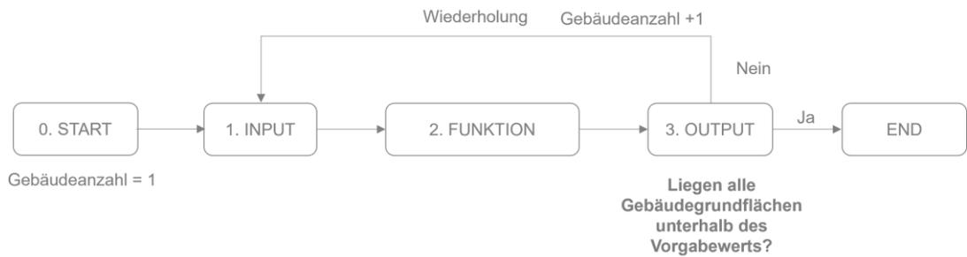
Abbildung 85 Programmabfolge (Iterativer Ansatz)
